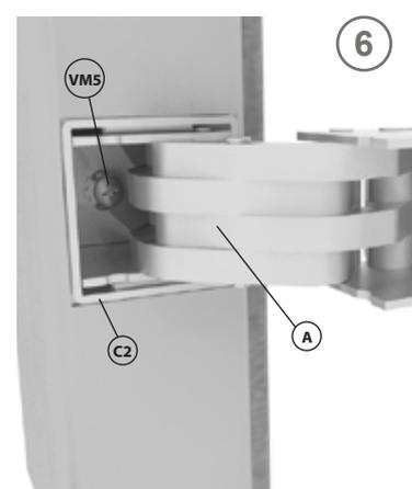
Fissare il corpo della cerniera (A) al supporto (C2) tramite l'inserimento della apposita viti (VM5) in dotazione.
